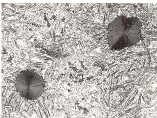
图 1 等温淬火球墨铸铁件金相结构 (×150)
