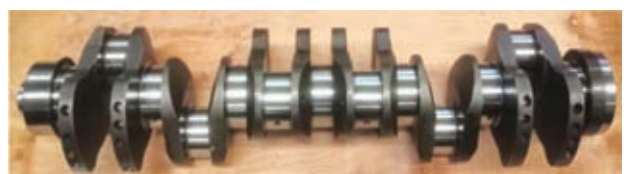
图14 船电6T球铁曲轴(疲劳极限弯矩11500 N·m)
