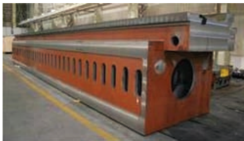
图9 低应力机床床身铸件 Fig. 9 Low stress machine tool bed casting
