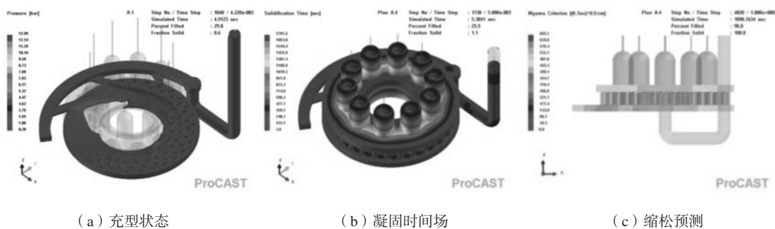
图10 图7中方案B充型凝固过程和缩松缺陷预测结果
