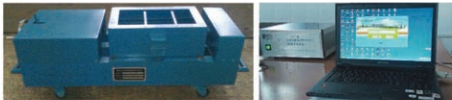
图18 铸造合金凝固特性新型检测装置
