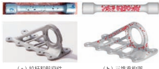
图23 钛合金拉伸杆和航空件原图及三维重构图
