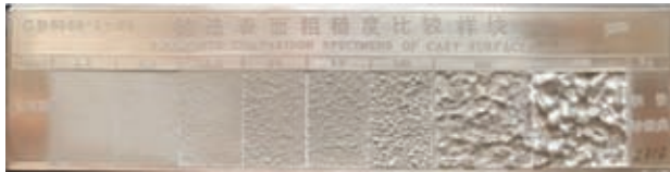
图21 铸造表面粗糙度标准样块(GB/T 6060.1-1985)实物照片 Fig. 21 Roughness standard specimens of cast surfaces (GB/T 6060.1-1985)
