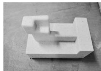
图5 硅溶胶浸渗、焙烧后砂芯形貌
