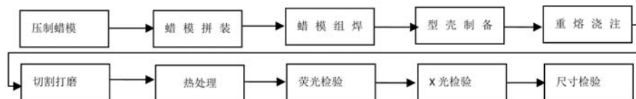
图2 产品主要工艺流程 Fig. 2 The main process flow
