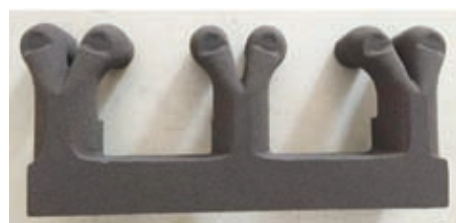
图9 SLS成形的某发动机水道砂芯
