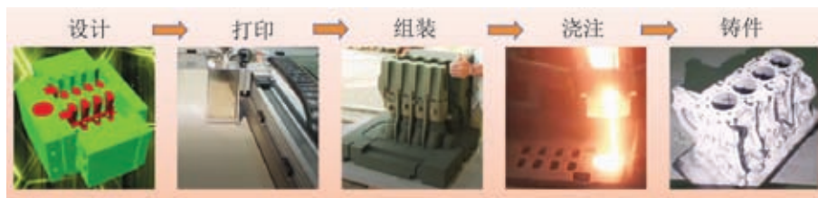
图2 3DP砂型铸造工艺流程
