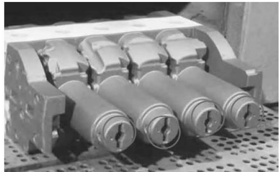
图4 主体芯缸筒部位的排气通道
