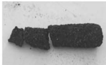
(b) 石墨冷铁焙烧后状态
