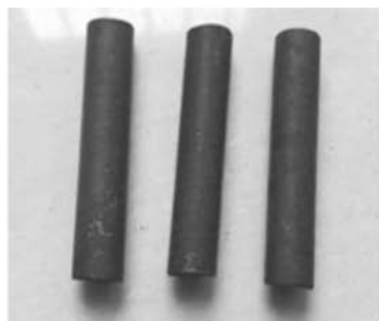
(b) 不锈钢冷铁焙烧后状态
