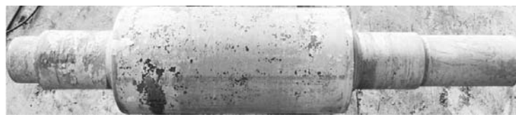
图12 工艺优化后生产的复合高速钢轧辊
