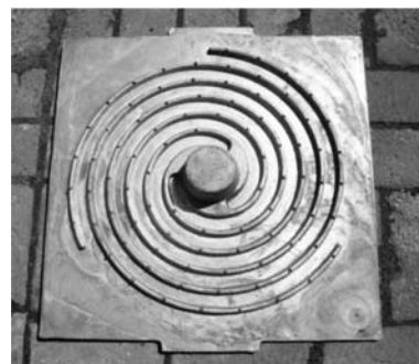
图10 生产的同心三螺旋形试样造型模板铸件产品
