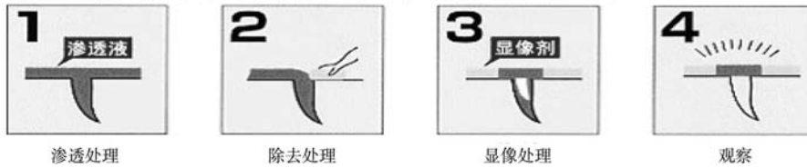
图7 渗透检测的基本过程
