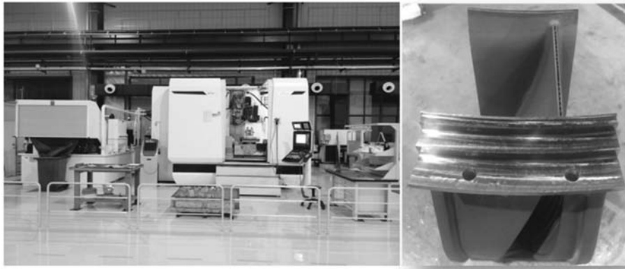
图4 五轴缓进强磨设备与涡轮叶片磨削效果
