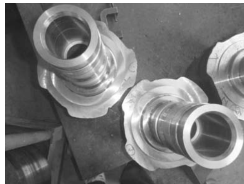
图7 铸件加工后暴露的缺陷
