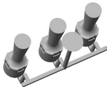
图9 零件浇注系统改进三维图
