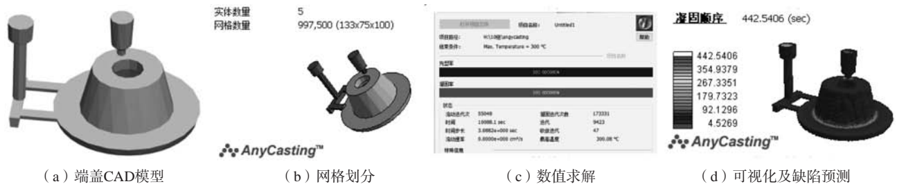
图6 轴承端盖CAE基础实验
