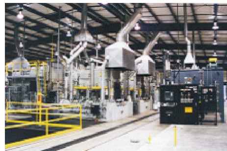
图 6 AFC-Holcroft 通用箱式等温淬火炉
