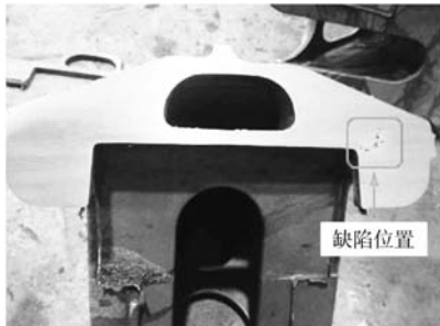
图10 铸件实际缺陷位置
