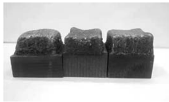
图7 采用两种扫描策略激光立体成形8 mm高度GH3536合金的实物图
