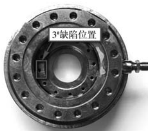
图5 3#缺陷位置 Fig. 5 3# Defect location
