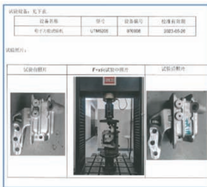
(b) 破坏试验过程
