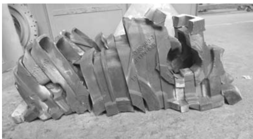
图7 箱体切片渗透探伤
