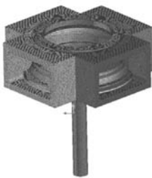
图3 模具及浇注系统网格模型
