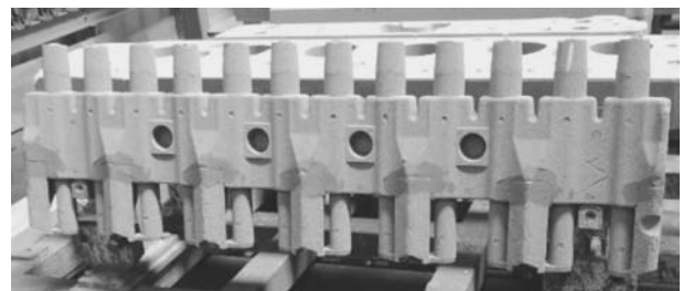
图1 陶粒砂+再生砂挺杆芯
