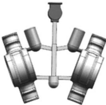
图4 阶梯浇注系统示意图
