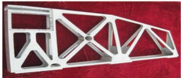
大型复杂薄壁异形曲面高强耐热镁合金铸件
