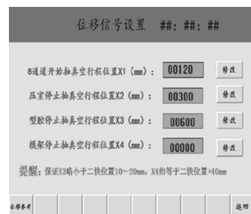
图4 离合器壳体试生产所用抽真空行程参数
