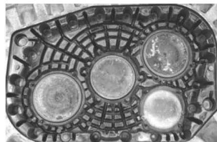
图5 定模型腔起模剂喷涂效果
