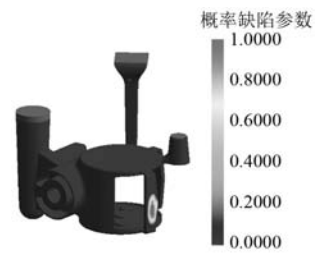
图9 工艺优化后的概率缺陷参数模拟结果
