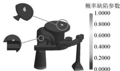
图4 概率缺陷模拟结果
