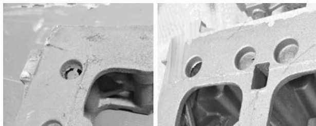
(a) 缸盖打磨前 (b) 缸盖打磨后
