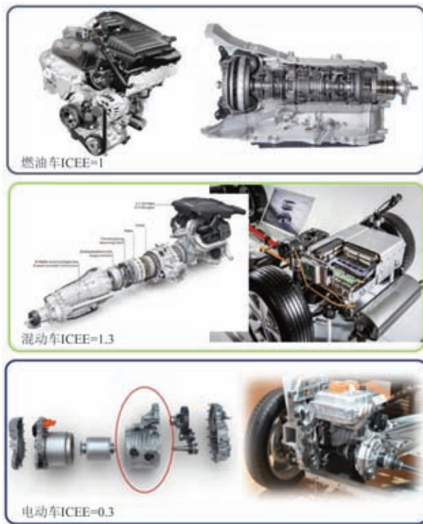
图6 三种车型动力及传动系统的压铸件应用指数
