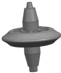
图6 陀螺砂芯示意图
