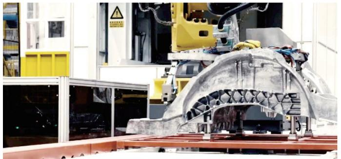
特斯拉发布官方视频，正式揭开其上海超级工厂6000吨级巨型压铸机的真相，以及中国造70个零部件合成为1的Model Y后底板一体大型压铸件的面貌。化零为整，化繁为简，压铸业强势回归高科板块。七次下调售价，一体压铸功不可没；实现一体压铸的，究竟是什么“神兽”；聊聊后期维修的那些事儿；一体压铸再升级，Cybertruck将使用8000吨压铸机……
