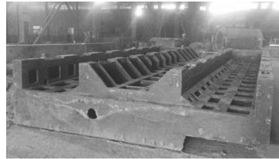
图4 型架底座铸件 Fig. 4 Framework base casting
