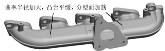
图3 优化后结构 Fig. 3 Optimized structure
