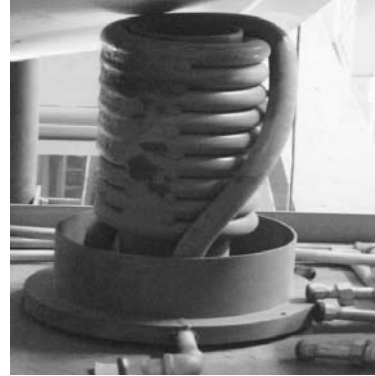
图9 螺旋管式水冷风口
