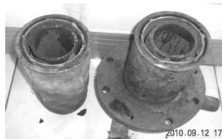
图11 有扰流筋的双腔风口剖开图
