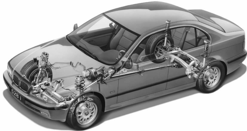
图1 宝马5系车身上使用的铝合金前后副车架
