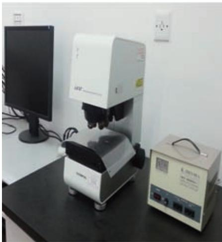
图2 激光共聚焦显微镜
