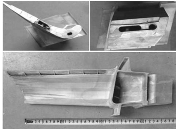
图8 完成脱芯的叶片试验件
